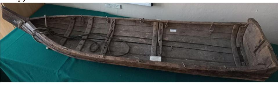
Центром керёжи служит гнутый березовый или еловый полоз (эль). По полозу расположены 5 пар 7 гнутых ребер, к которым с обеих сторон параллельно полозу прибиты по 3-4 узкие доски, составляющие борта керёжи. Конусообразный нос слегка приподнят, чтобы керёжа не зарывалась в снег, спинка отогнута для удобства ездока.
